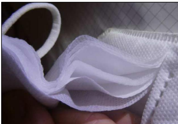
FFP2-Maske aufgeschnitten: 6 Gewebe-Schichten aus Kunstfasern
